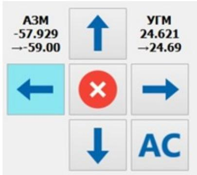
Панель движения антенны предназначена для управления и контроля движения антенны, контроля показаний датчиков углового положения по азимуту и углу места.
